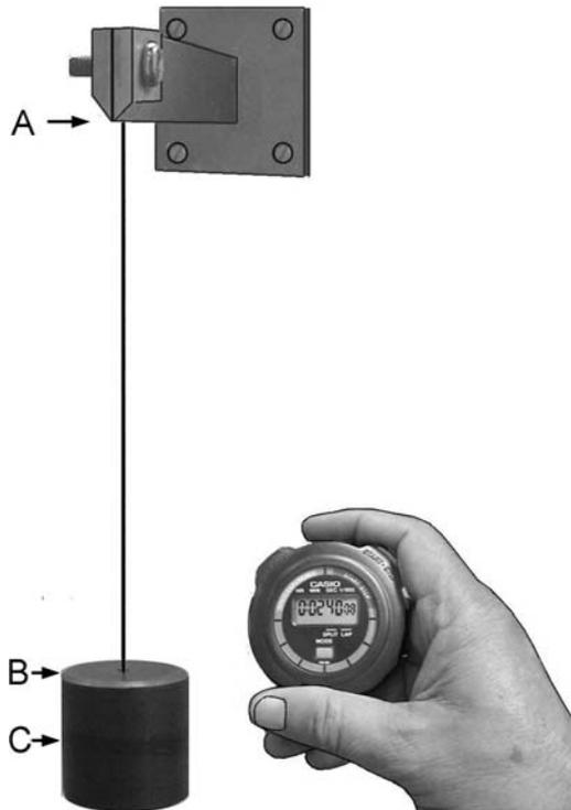
La masa de este péndulo no es puntual sino que es un cilindro metálico, de modo que la *longitud efectiva*  $L$  del péndulo, es la distancia entre el punto A donde se sujeta el hilo hasta el centro de masa C del cilindro. Esta es una consideración importante que deberemos tener en cuenta en el análisis de los datos experimentales. Para analizar correctamente los datos debemos percatarnos de que la longitud efectiva, del péndulo es:
