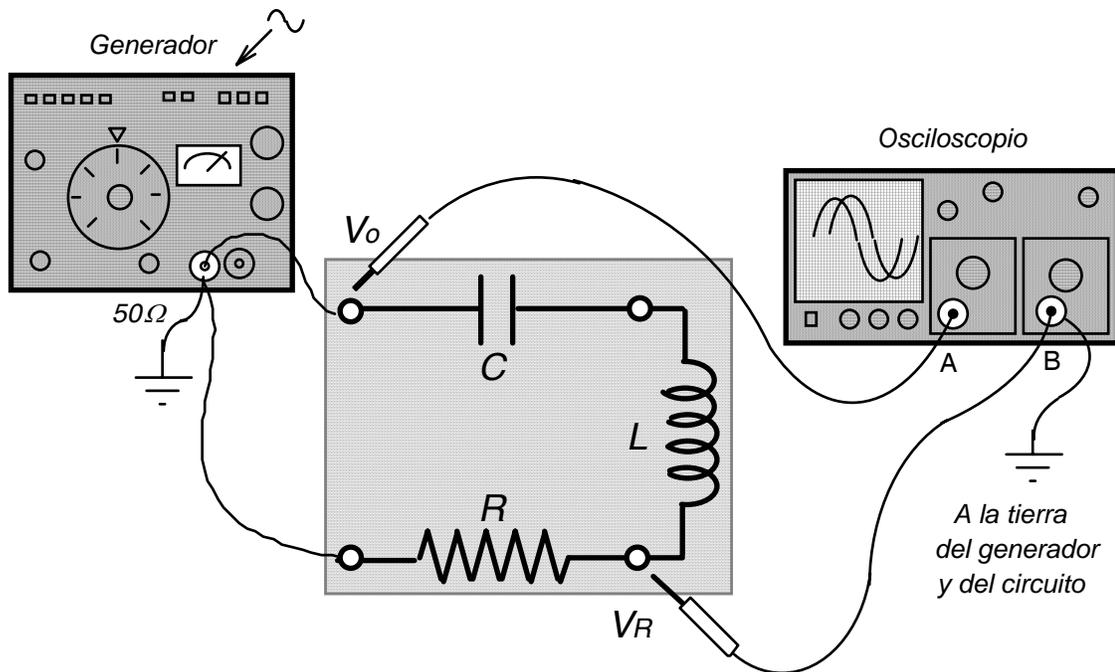
**Fig. 6:** Esquema del montaje experimental
