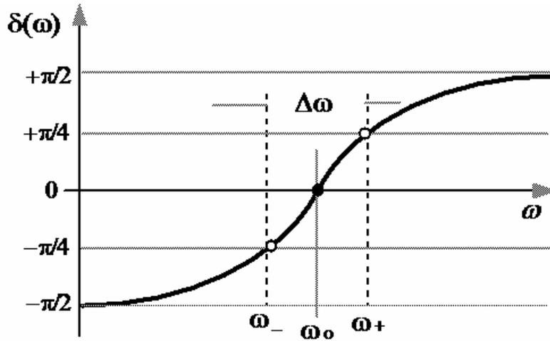
**Fig. 4:** Angulo de desfasaje de la corriente en función de la frecuencia
